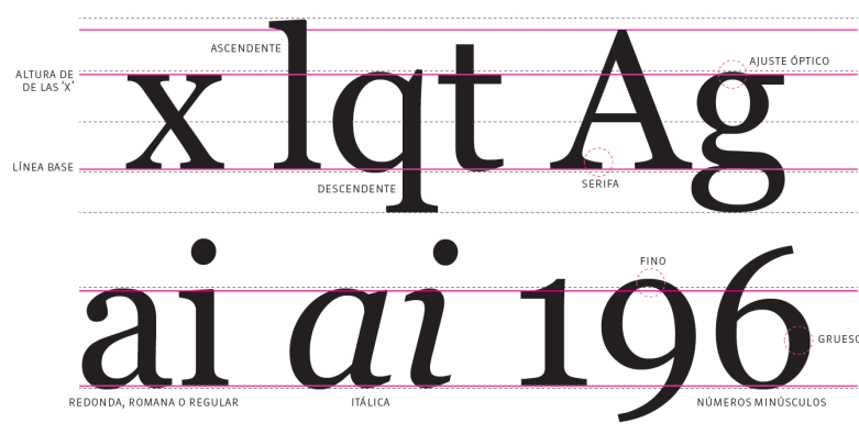
Figura 12. Una fuente para leerse en pantalla como Georgia tiene altura de las ‘x’ elevada, un contraste no exagerado y contraformas francas –los espacios negativos no tienen recovecos marcados. El propósito es no perder claridad en el reconocimiento de los caracteres en tamaños pequeños dado el número de píxeles disponibles para desplegarlos.
